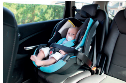
Het babyzitje is in de verkeerde richting geïnstalleerd
