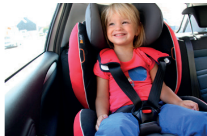
De riempjes van het kinderzitje zelf zijn onvoldoende aangespannen
