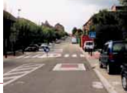
Het rijbaankussen doet de auto's vertragen vóór een oversteekplaats voor voetgangers.
